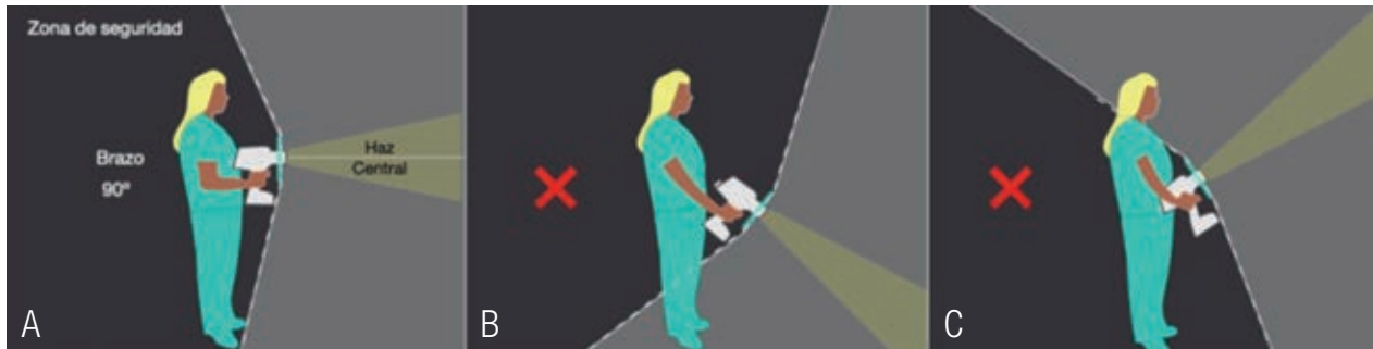
Figura 3. Influencia del ángulo de estabilización del equipo portátil de rayos X: A, Uso correcto del disco de retrodispersión A. con el cilindro localizador paralelo al piso; B, uso incorrecto del disco de retrodispersión con el cilindro apuntando hacia el piso; C, uso incorrecto del disco de retrodispersión con el cilindro apuntando hacia el techo.
