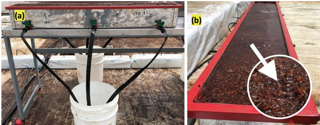
Figura 3. Recipiente metálico con sus respectivos drenajes (a) que contiene una tabla de fibra de coco saturada de un volumen aproximado de 18,2 L (b).
