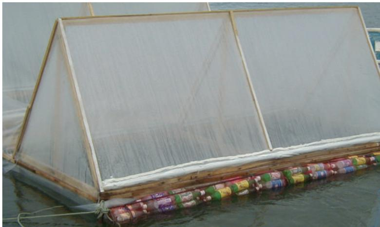
Fig. 3. Prototipo del modelo de tienda de destilación. Las gotas de agua destilada pueden verse escurriendo por el lado del plástico. Dentro de las cámaras el calor se concentra y la evaporación aumenta.
