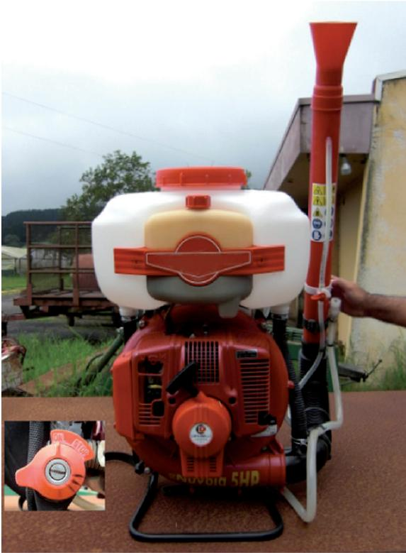
**Figura 1.** Vista trasera de la bomba de motor utilizada para la distribución de semillas forrajeras de alpiste (*Phalaris canariensis*) y linaza (*Linum usitatissimum* L.). Cartago, Costa Rica. 2010.
