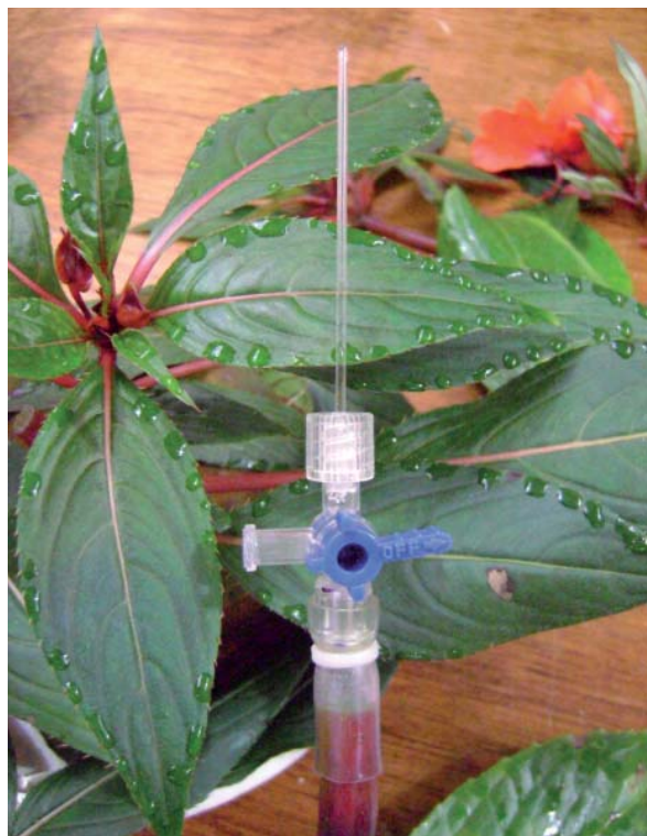
Figura 4. Manómetro de burbuja instalado en una planta de china ( Impatiens hawkeri ). Se observa la gutación, una forma de "exudación" evidenciada por la formación de gotas en los márgenes de las hojas. Estación Experimental Fabio Baudrit Moreno, Universidad de Costa Rica. 2011.
