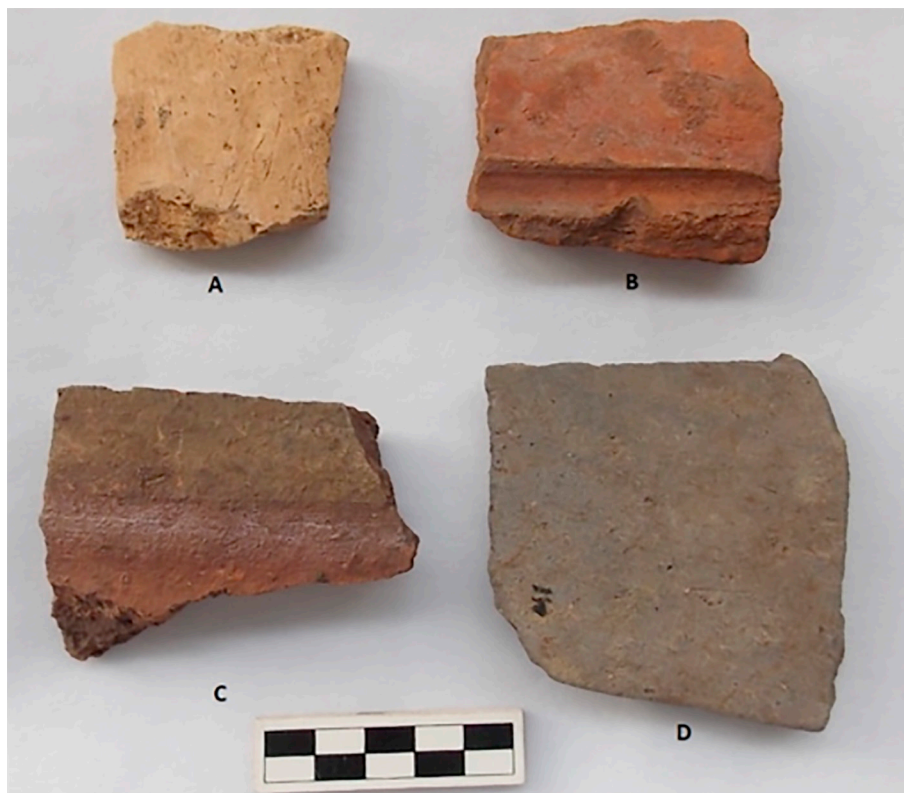
Figura 3: A) Teja crema; B) Teja café rojizo siglo XVIII y XIX; C) Teja café rojizo con impermeabilizante; D) Teja gris elaborada a alta temperatura.
