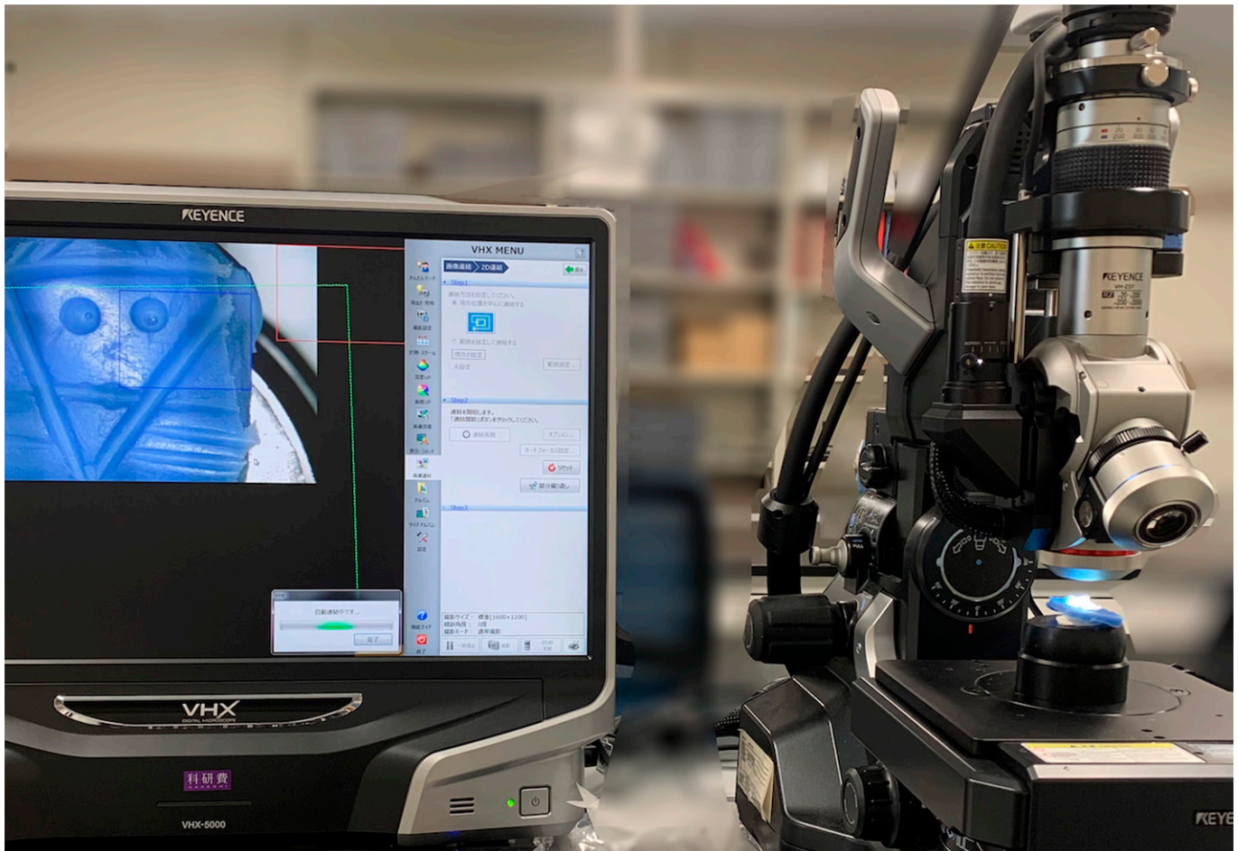
Figura 5: Análisis de uno de los moldes de silicona con el microscopio digital Keyence VHX-5000.
