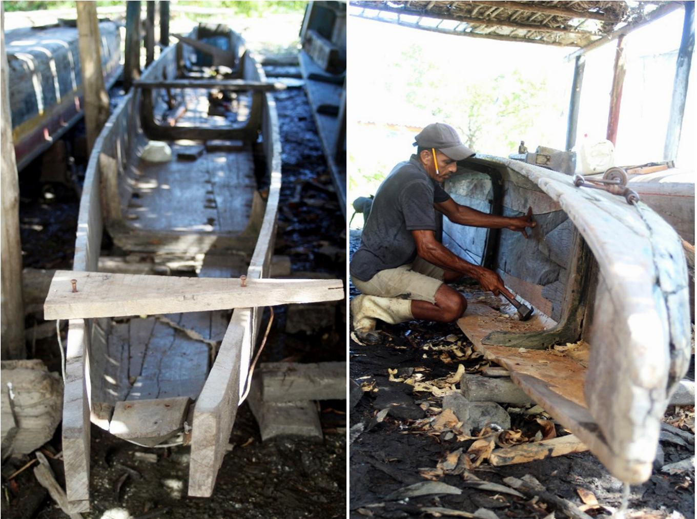
**Figura 7:** Izquierda, proceso de construcción de una canoa “doble proa” (proa = popa) en tablas. Derecha, proceso de reparación de canoa por el carpintero Daniel Cervantes. Fotografías del autor.
