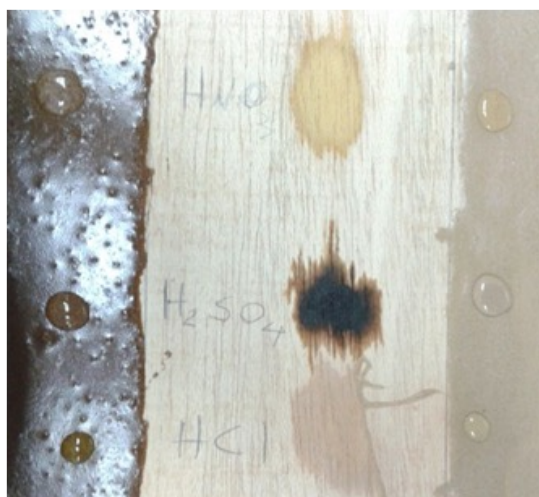
Figura 3. Resistencia a la corrosión de las mezclas de barniz con diatomita (izquierda) y con arcilla (derecha), 16 días después de la aplicación.
