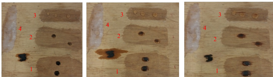
Figura 2. Aplicaciones de ácido sulfúrico a diferentes concentraciones de barniz: izquierda 1 hora, centro 24 horas y derecha 6 días después de la aplicación.
