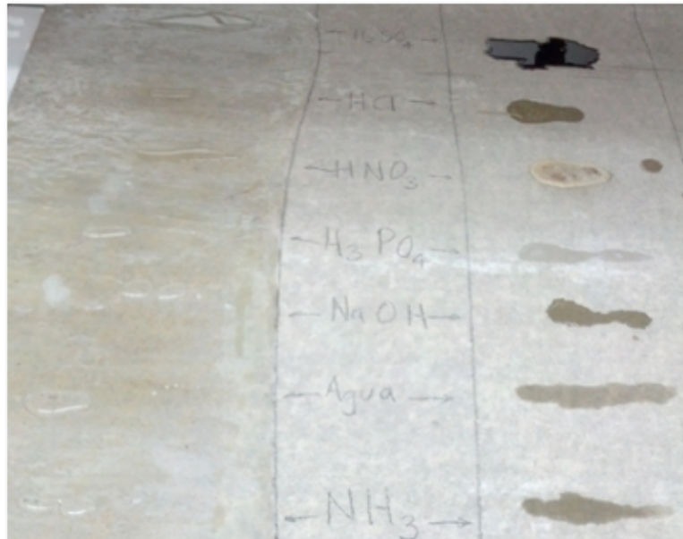
Figura 4. Aplicación de diferentes productos corrosivos en materiales prensados con y sin protección por barniz.
