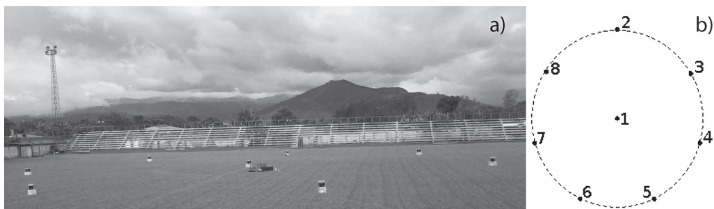
Fig. 2: a) Ubicación de sensores en una cancha de fútbol en el estadio de Palmares. b) Disposición circular en planta de 8 sensores, cuyo radio suele variar entre 30 y 50 m (radio grande) y entre 15 y 25 m (radio pequeño).
