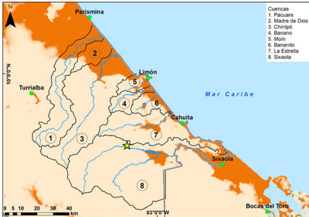
Fig. 13: Áreas afectadas por la licuefacción debido al terremoto del Valle de La Estrella, el modelo de licuefacción fue elaborado por Zhu et al. (2017) y facilitado por el Centro Nacional de Información sobre Terremotos del USGS (2020) ( https://earthquake.usgs.gov/earthquakes/eventpage/usp0004qpg/ground-failure/summary ), además se incluye la cartografía propuesta por Soulas (1991), la cual muestra una alta coincidencia al modelo de Zhu et al. (2017). La licuefacción se concentró en la costa y afectó ciudades como Limón en Costa Rica y Bocas del Toro en Panamá. El epicentro del terremoto se indica por una estrella amarilla y principales poblados por círculos verdes.
