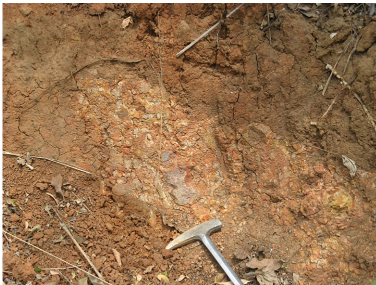
Fig. 14: Capa de laterita las grietas contractivas indican contenido de minerales arcillosos plásticos (13,639820°, -89,255502°).
