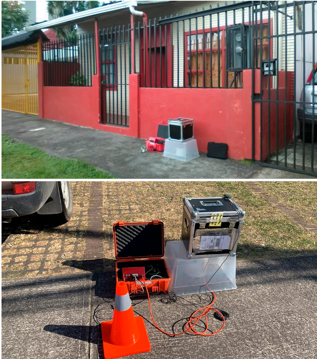
Fig. 2: Ejemplos de sitios donde se colocó el equipo de medición de ondas superficiales, priorizando superficies rígidas en contacto con el suelo, como las losas de concreto.
