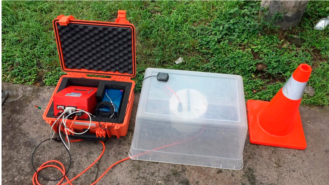
Fig. 1: Digitalizador (caja naranja a la izquierda) y sensor (dentro de caja transparente a la derecha) utilizados en la campaña de medición. El digitalizador es marca SARA y el sismógrafo usado como sensor triaxial es marca Lennartz.
