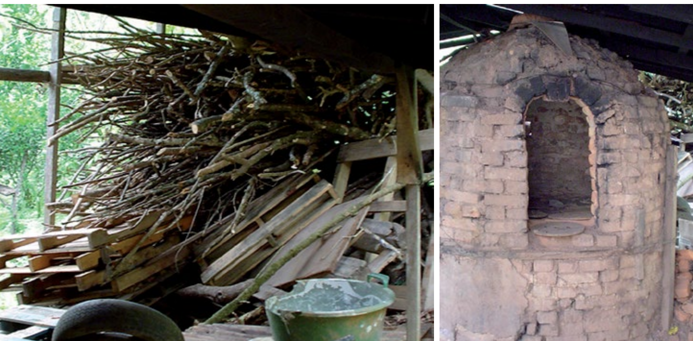
Horno estilo Santa Ana, utiliza leña como combustión para cocer y acabar las piezas cerámicas. (2009). Fotografía Ivette Guier.
