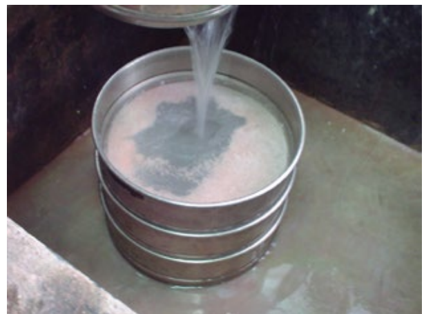
Lavado de la arcilla a través de diferentes tamices. (2011). Fotografía Ivette Guier.
