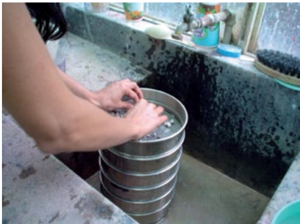
Lavado de la arcilla a través de diferentes tamices. (2011). Fotografía Ivette Guier.
