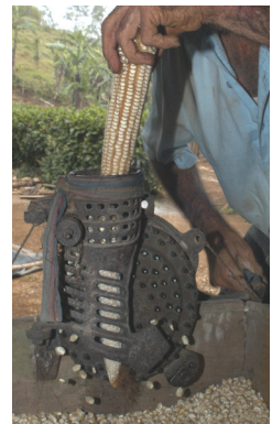
Secuencia del uso de una desgranadora de mazorcas.
