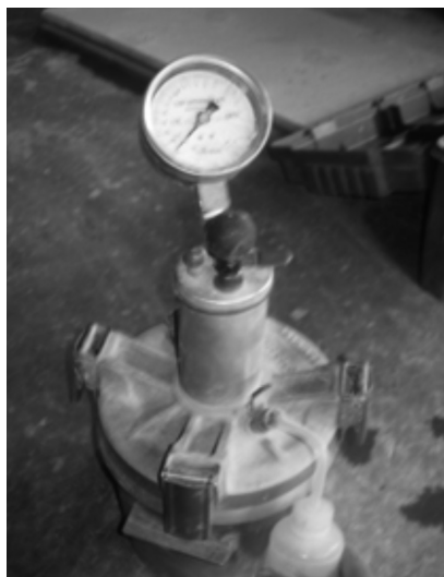
Figura 4. Equipo utilizado para medir el porcentaje de aire en el mortero.
