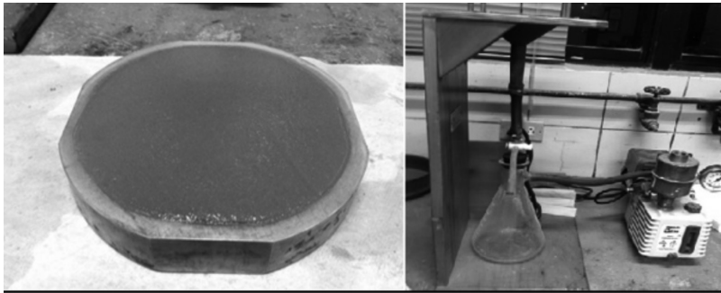
Figura 3. Espécimen para la prueba de retención de agua y equipo utilizado.
