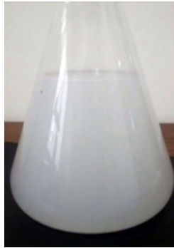
Figura 4. Dispersión en agua del Tween 85 y Span 85 (5mL de emulsión en 1L agua) Nota: Fuente propia del estudio.
