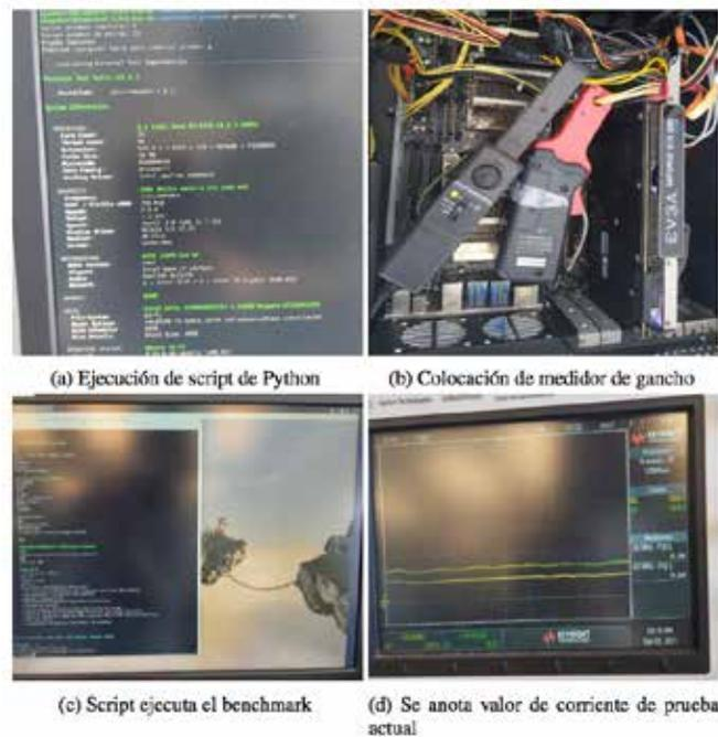
Fig. 1. Mediciones de corriente demandada durante pruebas.
