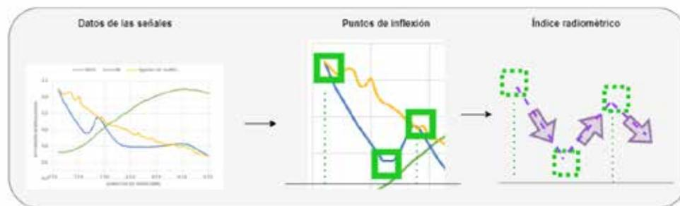
Fig. 1. Flujo general del algoritmo creado para identificar monotonías de los diferentes espectros de los componentes o agentes analizados.
