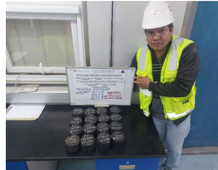
Fig. 2. Obtención de la mezcla asfáltica.
