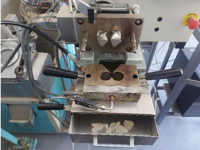
Fig. 1. Cámara de mezclado del plastógrafo.
