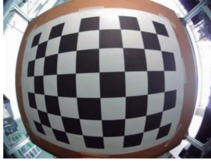
Fig. 2. Imagen distorsionada al utilizar lente gran angular
