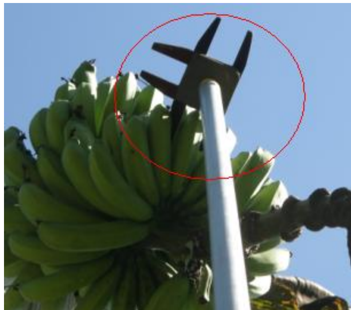
Figura 2. Determinación del calibre de la fruta con la estructura extendible y los calibradores fijos. Fuente: Foto tomada por los autores.
