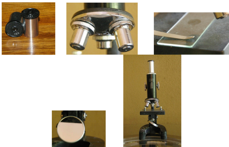
Fuente: fotografías tomadas por la autora, 2021. De izquierda a derecha, fila superior: ocular, objetivo, porta objetos. Fila inferior: espejo, microscopio completo.
