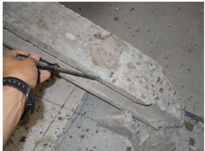
Figura 13. Falla de columna ensayada con el método de cargas en los tercios por agrietamiento en el tramo central
