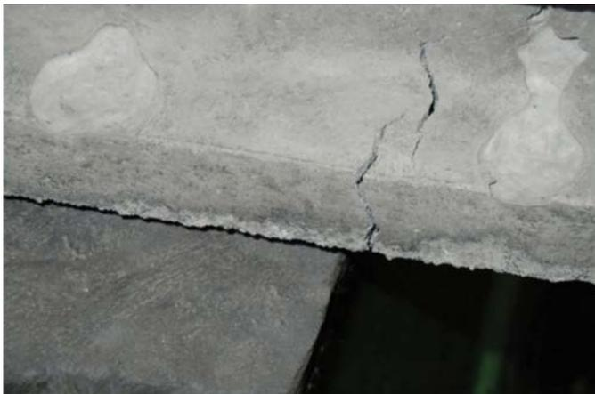
Figura 10. Falla de columna pre-esforzada en flexión mediante carga aplicada en voladizo
