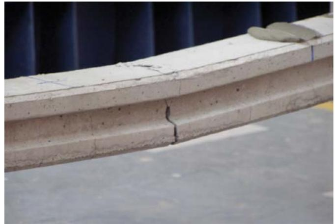
Figura 12. Agrietamiento en la sección central de la columna ensayada con el método de cargas en los tercios
