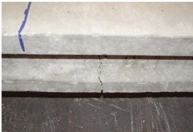
Figura 11. Falla de columna reforzada en flexión mediante carga aplicada en voladizo
