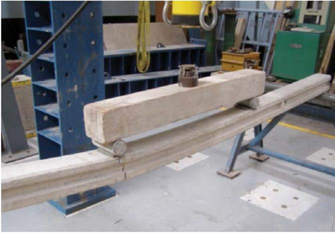
Figura 14. Agrietamiento en punto de aplicación de carga en columna ensayada con el método de cargas en los tercios
