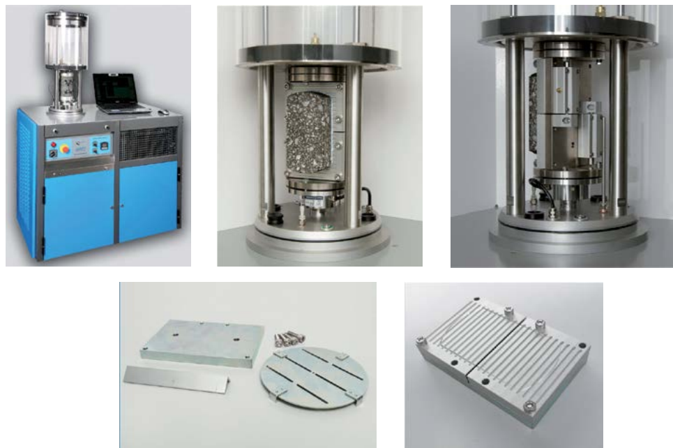
Figura 4. Equipo AMPT con los aditamentos para Overlay Fuente: AMPT OLT0512 IPC Global, 2012 [Ref. 7]
