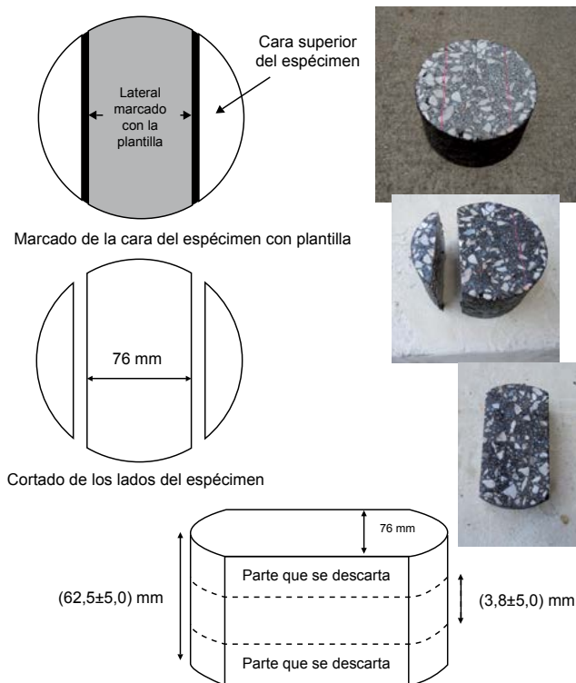
Figura 7. Cortado de 1 briketa para ensayo de Overlay
