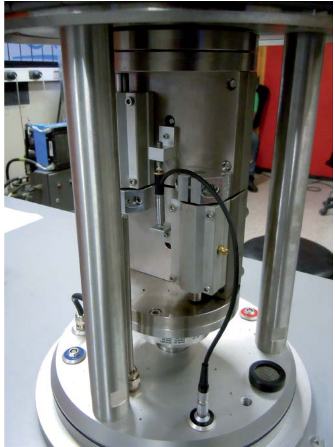
Figura 11. Montaje del deformímetro
