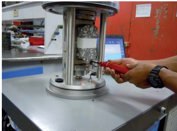
Figura 10. Montaje de la muela del ensayo en el equipo
