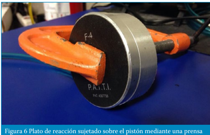
Figura 6 Plato de reacción sujetado sobre el pistón mediante una prensa
