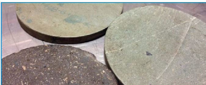
Figura 4 Ejemplo de agregados preparados para su uso en el ensayo ABS.
