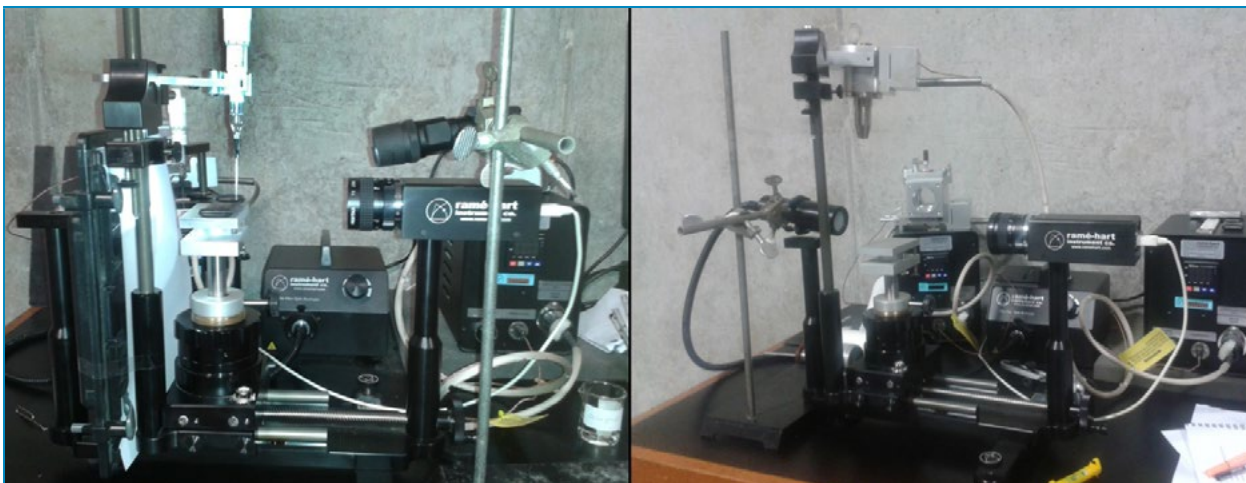
Figura 2 Equipo de goniometría (a) con gotero manual (b) con jeringa dispensadora.
