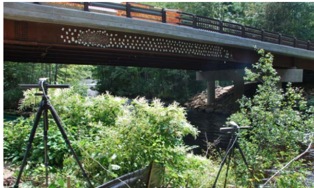
Figura 17. Instalación de las manchas aleatorias para el método CID. Fuente: Santini et al., 2011 [ref. 46].
