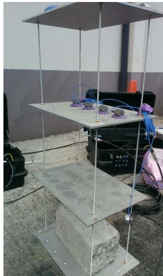
Figura 44. Validación de la sincronización colocando 4 acelerómetros en el mismo piso del modelo de edificio de 3 pisos.
