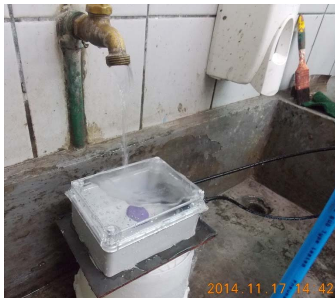
Figura 32. Prueba de protección contra el agua de la caja de protección.
