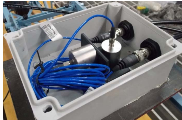
Figura 31. Caja de protección fabricada como una unidad biaxial de medición de aceleración.
