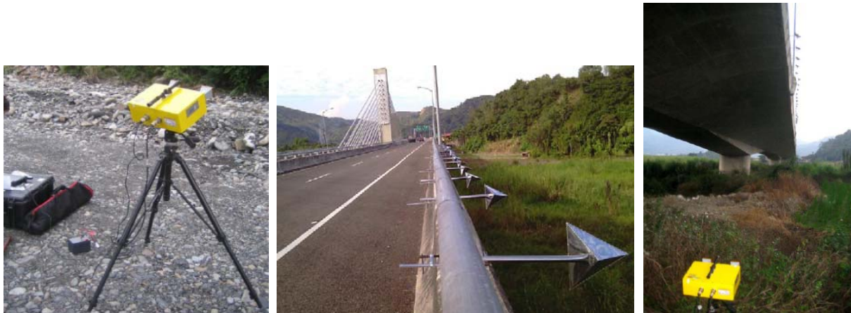
Figura 11. Instalación del equipo IBIS-S durante la medición del Puente Ai-Lan, Taiwán. Fuente: Hsu et al., 2011 [ref. 34].
