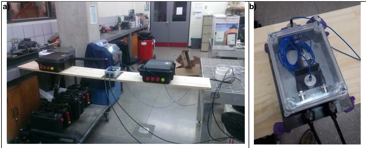
Figura 33. a) Prueba de la señal vertical mediante una tabla de madera flexible, b) acercamiento a los acelerómetros instalados dentro de la caja de protección y los que están en contacto directo.
