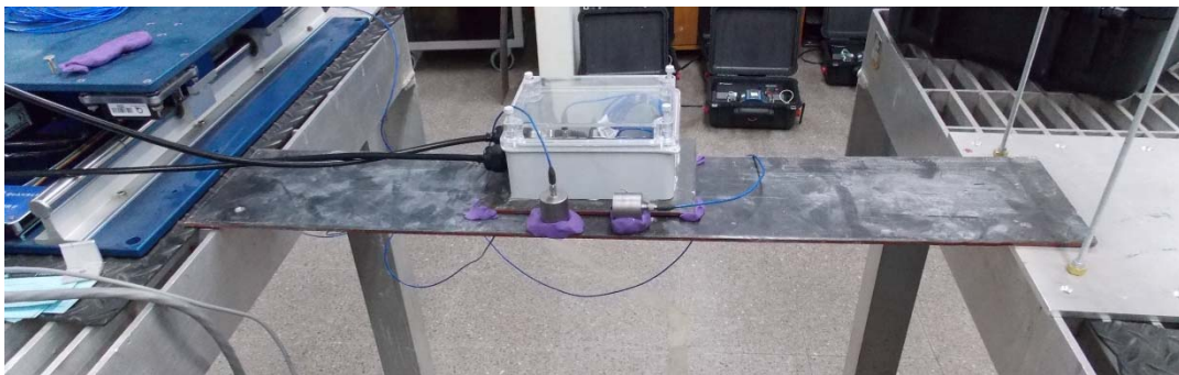
Figura 36. Prueba de la señal vertical mediante una tabla de acero rígido.
