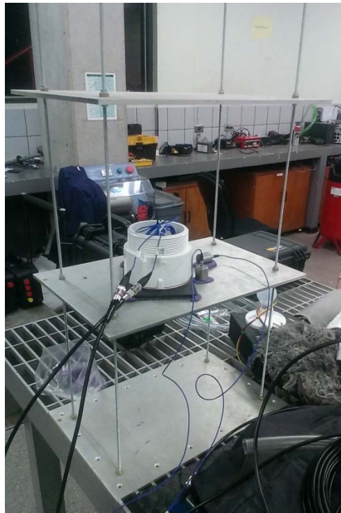
Figura 39. Prueba de la señal horizontal utilizando el modelo de edificio de 3 pisos.
