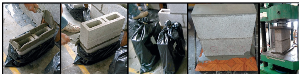
Figura 3. Construcción y falla de los prismas
