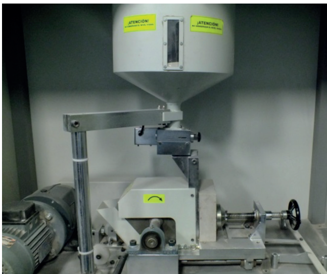
Figura 4. Equipo Método de la banda ancha. (Laboratorio De Resistencia de Materiales PUCE, 2017)
