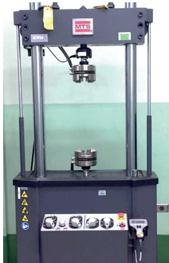
Figura 2. Máquina Universal utilizada en los ensayos de tracción
