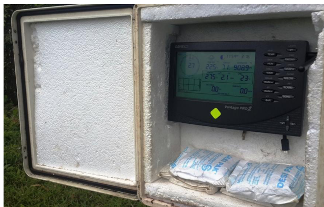
Figura 2. Aislamiento que tiene la consola
