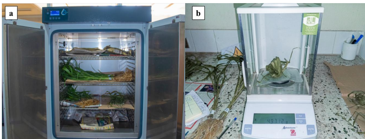
Figura 1. Preparación de muestra vegetal, para los cálculos de pesos en materia seca: a) muestras colocadas al horno a 70 °C, b) recolecta de datos de la variable peso seco aéreo y de raíz en balanza analítica.
