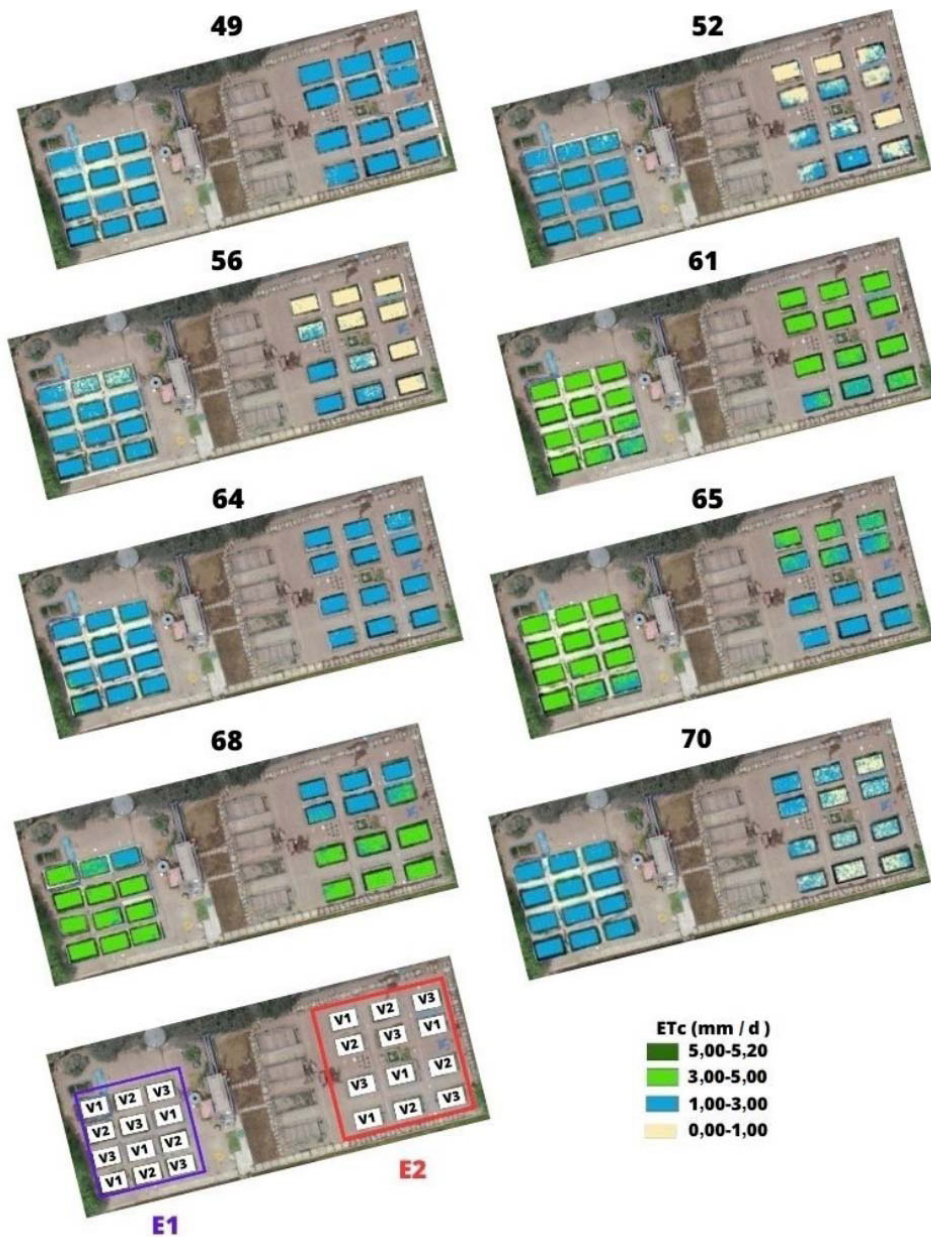
Figura 6. Distribución espacial de la evapotranspiración de cultivo (ETc) obtenida por balance de energía del modelo METRIC en el cultivo de arroz ( Oryza sativa ), en el Área Experimental de Riego (AER) de la Universidad Nacional Agraria La Molina, Lima, Perú, 2019.
