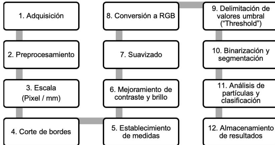
Figura 3. Proceso del análisis digital de imágenes utilizado para evaluar los granos de arroz ( Oryza sativa L.). Costa Rica, 2022.
