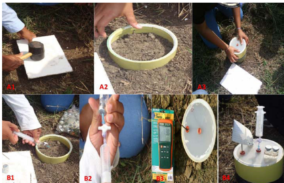
Figura 1. Cámaras utilizadas para monitorear los flujos de metano del suelo con diferentes coberturas de pastos: a) instalación de cilindros y cámaras de muestreo; b) proceso de muestreo. A1: instalación de cilindro; A2: cilindro instalado; A3: cilindro con cámara de muestreo; B1: toma de muestra inicial de gases; B2: traspaso de aire de la jeringa al vacutainer; B3: determinación de la temperatura del suelo; B4: toma de muestra de aire de la cámara cerrada. Valle medio del río Sinú, Córdoba, Colombia. 2014-2015.
