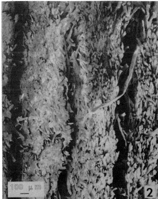
Fig. 1. Mezcla de cemento, cal y fibras, producto de desecho industrial para formar paneles divisorios (76x) Fig. 2. Aglomerado formado de varias capas de fibras provenientes de material reciclado (38x)
