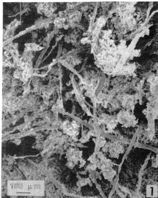
Fig. 1. Mezcla de cemento, cal y fibras, producto de desecho industrial para formar paneles divisorios (76x) Fig. 2. Aglomerado formado de varias capas de fibras provenientes de material reciclado (38x)
