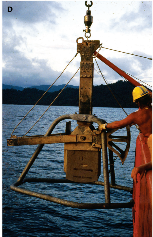
Fig. 1. A. Buque científico Skimmer (1979-1981). B. Operación de la draga ( grab ) Smith- McIntyre modificada. Golfo de Nicoya, Pacífico, Costa Rica. Ver; Maurer & Vargas (1984), Maurer, Vargas & Dean (1988). C. Buque científico Victor Hensen (1993-1994). D. Operación del barreno de cajón ( box corer ). Estuarios de Golfo de Nicoya y Golfo Dulce. Pacífico. Costa Rica. Ver: Dean (1996, a, b) y León-Morales & Vargas (1998).
