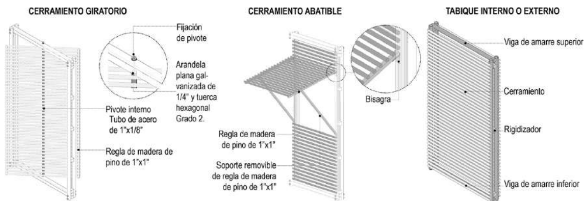
Figura 7. Cerramientos móviles y paneles tipo tabiques no estructurales
