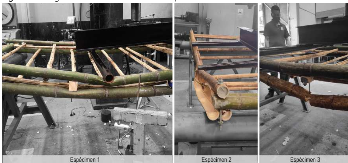
Figura 16. Fotografía de las fallas a flexión de los especímenes
