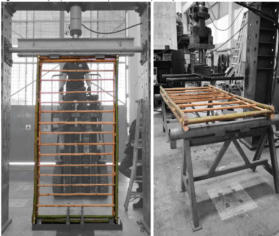
Figura 12. Montaje experimental de las pruebas de compresión y flexión
