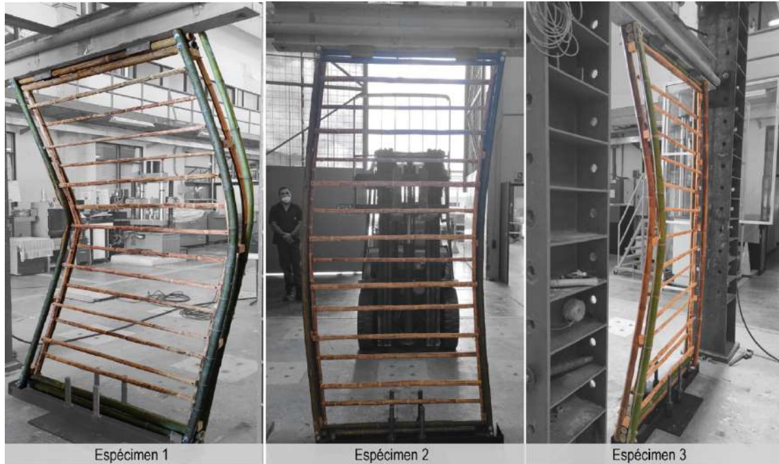
Figura 14. Fotografía de las fallas a compresión de los especímenes
