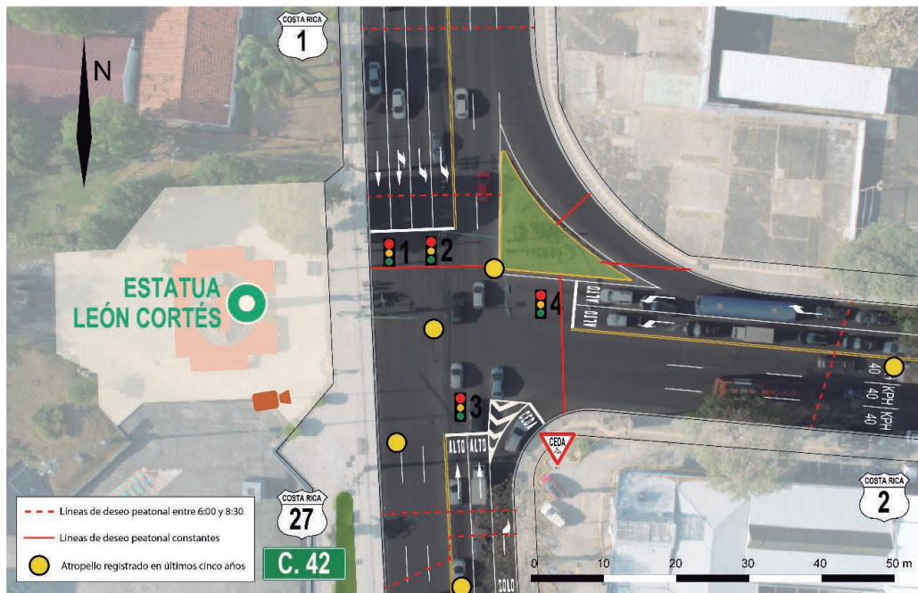
Fig. 1. Levantamiento geométrico del sitio León Cortés, líneas de deseo peatonal y atropellos registrados.
