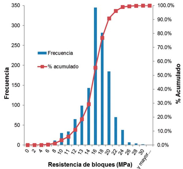
Figura 2. Histograma de valores de resistencia de bloques para la base de datos completa.
