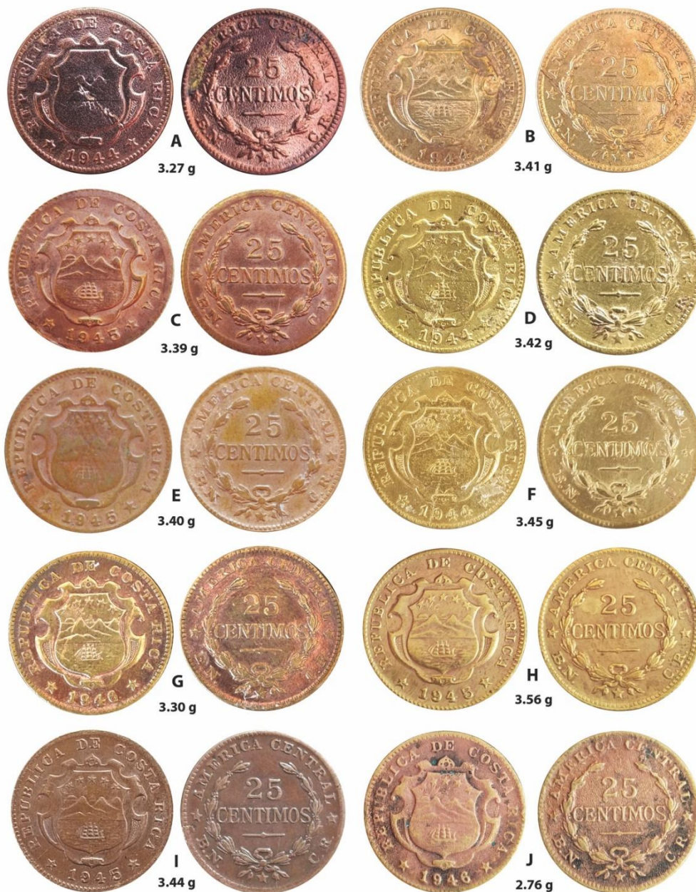
Figura 5. Variación en el color de 10 monedas de 25 céntimos y su peso en gramos. Las pesetas H y J corresponden al peso máximo y al peso mínimo, respectivamente. Los resultados del análisis de la concentración de metales por SEM-EDX para cada una están incluidos en la Figura 6.
