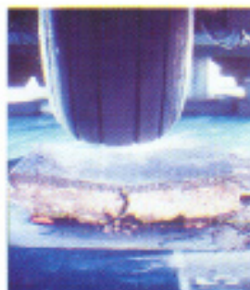
Figura No. 3: Mecanismo de falla de carpeta ante cargas repetidas
