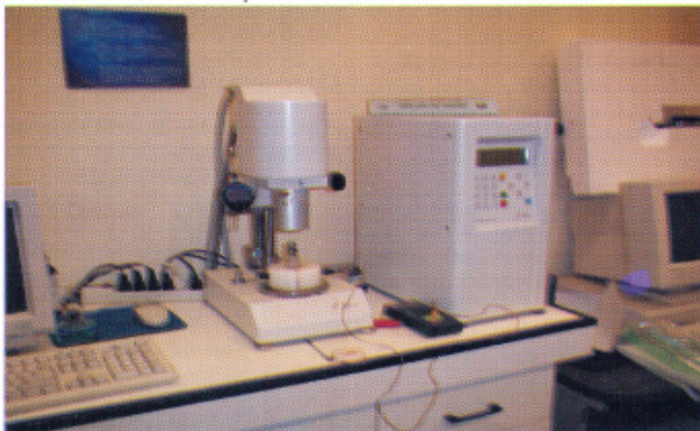
Figura No. 1 Reómetro dinámico de cortante. Dispositivo para la evaluación de la rigidez al cortante de los ligantes asfálticos, con temperaturas y medias de operación.
