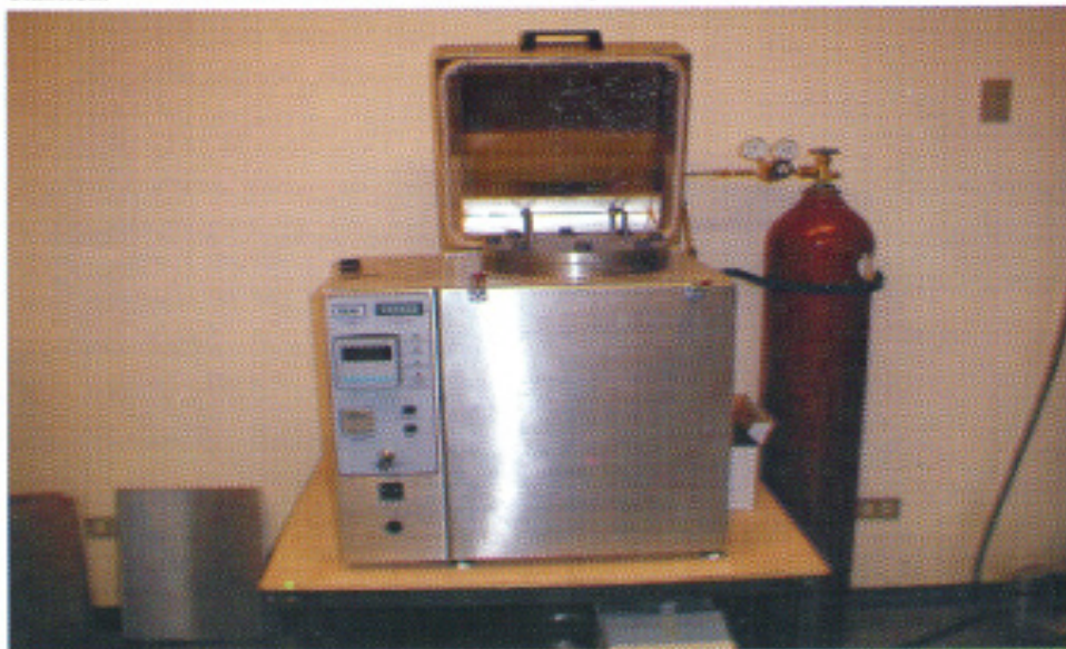
Figura No. 3 Dispositivo de envejecimiento a presión. Dispositivo para simular el envejecimiento del ligante asfáltico durante un periodo de 5 a 10 años de servicio
