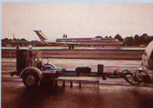
Figura 1: Esquema general del trailer de medición (FWD8000)
