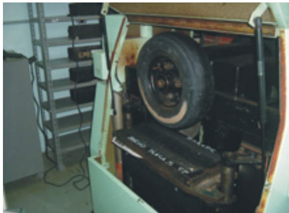
Figura 7. Cámara termo-regulada de la máquina de deformación permanente
