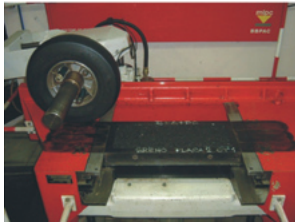
Figura 6. Mesa compactadora de los bloques de las mezclas asfálticas
