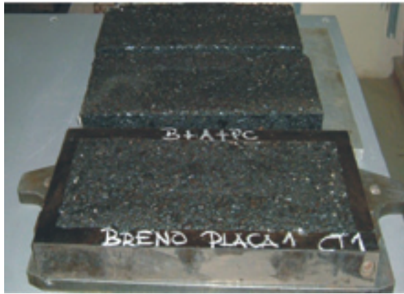
Figura 5. Molde metálico de compactación de los bloques
