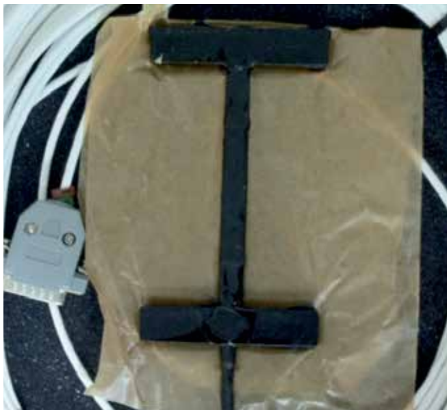
Figura 11. Transductor para medición de deformaciones unitarias.
