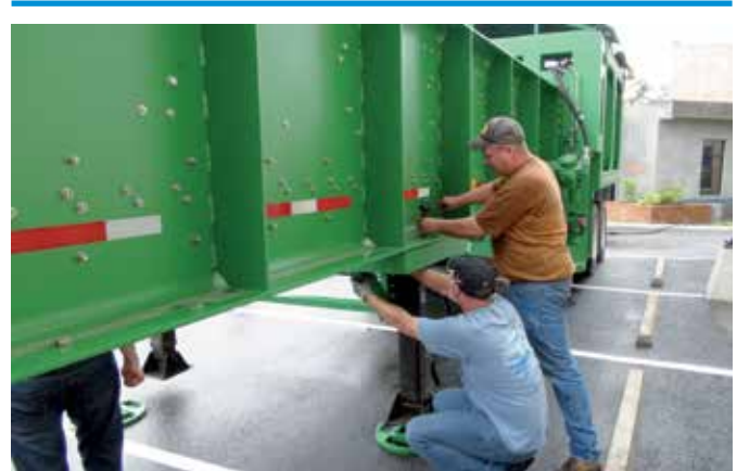
Figura 5. Calibración de la celda de carga
