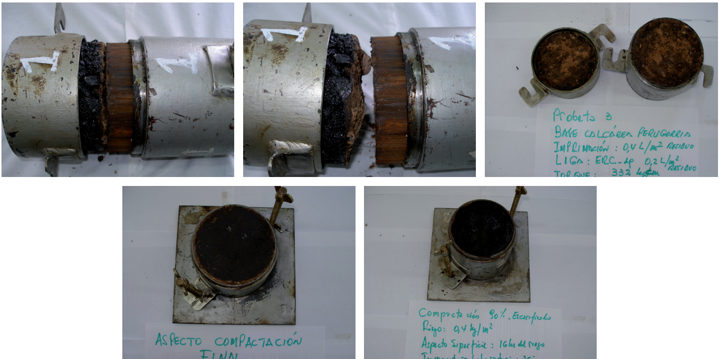
Fotos 15 a 19. Aspecto de la rotura de las probetas en Bases de Tosca Correntina (Argentina).
