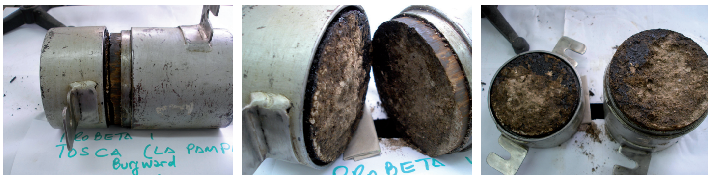
Fotos 9 a 11. Aspecto de la rotura de la probeta, en la tosca Pampeana (Argentina).
