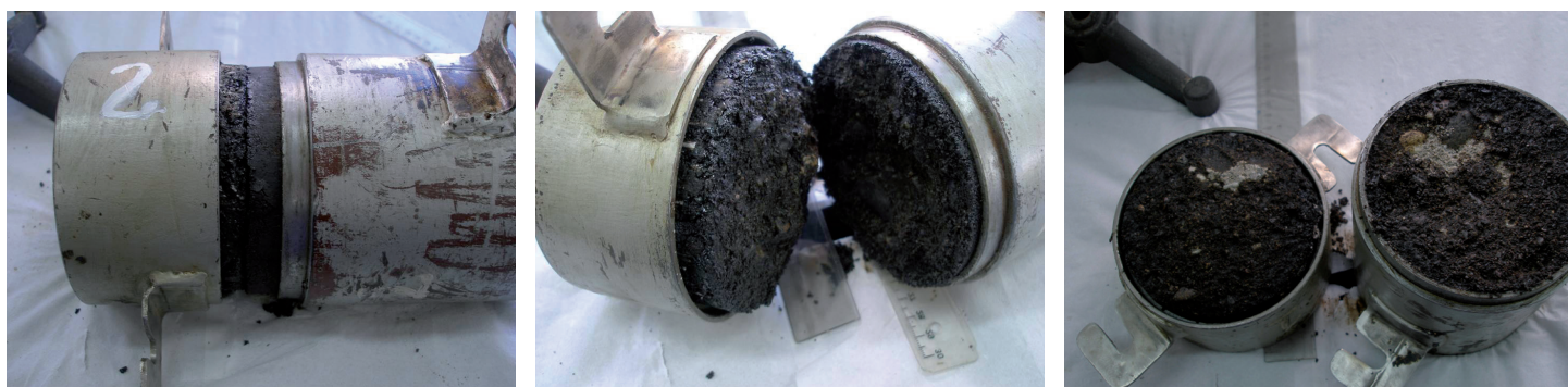
Fotos 12 a 14. Aspecto de la rotura de las probetas en la Base Anticongelante (Argentina).
