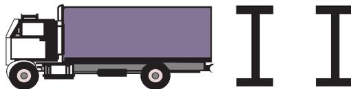
Camión con eje dual trasero (C2)
