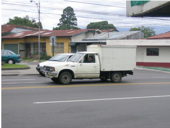
Figura 3 Camión con eje simple trasero (C2+)
