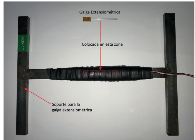
Figura 3. Galga extensiométrica
