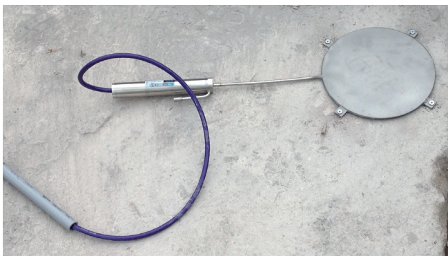
Figura 2. Celda de presión utilizada para la instrumentación de pavimentos (LanammeUCR, 2015)
