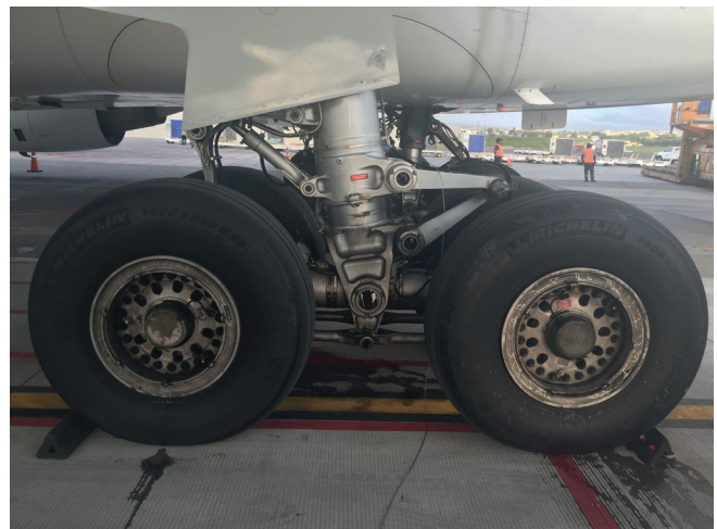
Figura 11. Configuración de las llantas de la aeronave en estudio A340-600
