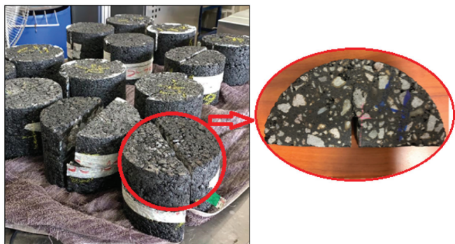
Figura 3. Especímenes ensayo viga semi-circular
